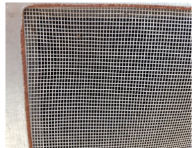
À gauche : vu sur la trappe de l'augmentorium ; au centre : vu sur la grille arrière ; à droite : gros plan sur la maille de la grille (1,8mm x 1,8mm)
