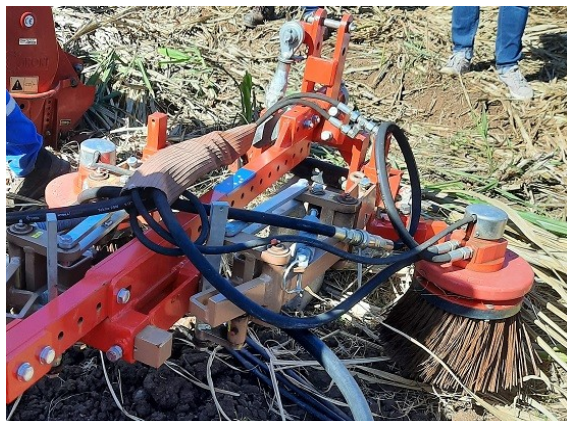
Présentation d'outils de désherbage mécanique Brosses de déherbage
